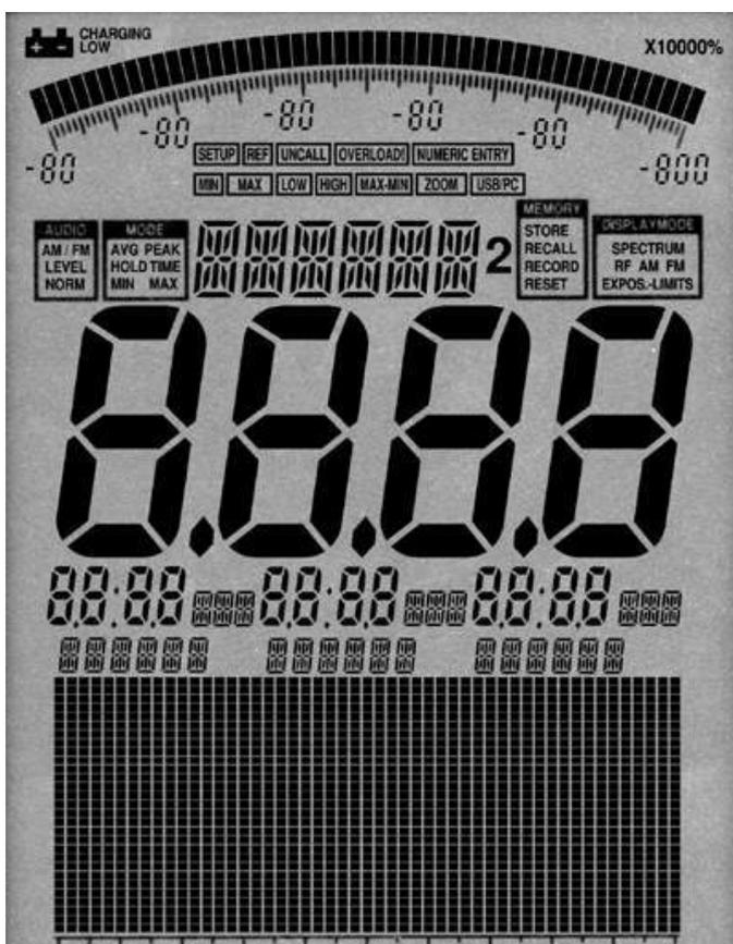
**SIS-SPECTRA** dispone di un ampio e pratico display LCD per la visualizzazione in tempo reale delle operazioni in corso e dello stato del dispositivo:
